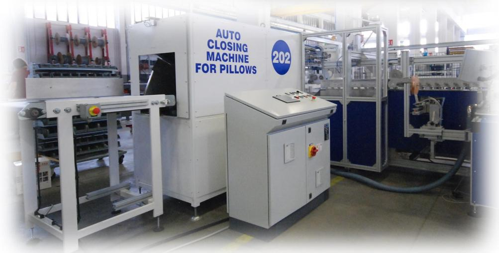
La macchina INSACCATRICE AUTOMATICA PER GUANCIALI BM202 è stata progettata e realizzata da BROSIOMECCANICA per automatizzare il processo di inserimento dell'anima del guanciale in fibra di poliestere cardata all'interno della federa.
